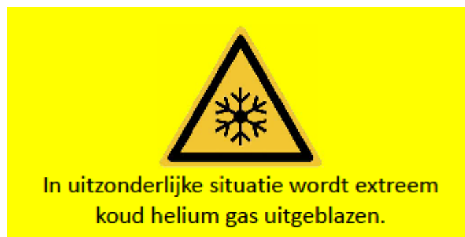
Figuur B5. Voorbeeld voor signalering bij de uitlaat van de quenchpijp, met symbool uit de NEN-EN-ISO 7010 norm.
