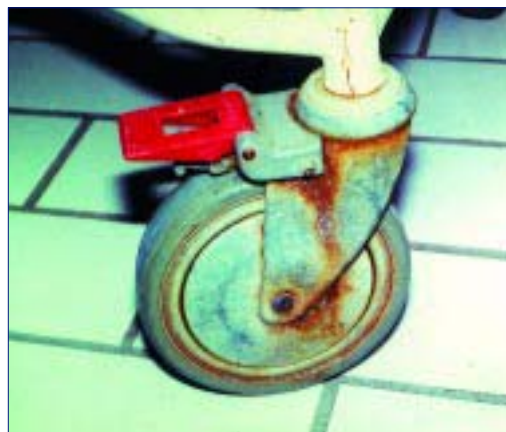
Slecht onderhoud van wielen, waardoor het hulpmiddel niet meer soepel rijdt. Toename van de fysieke belasting van zorgverleners en andere medewerkers.
